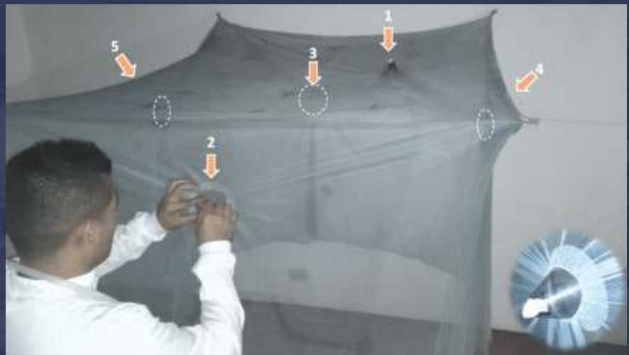
Figura 3. Instalación y ubicación de conos en cada una de las caras del toldillo impregnado permost VPM® (Tratamiento), para realización de pruebas de residualidad con Aedes aegypti . Fuente: J. De las salas (2017).
