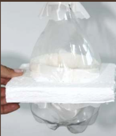
Figura 3. Jaula centinela donde se colocan las larvas para la exposición
