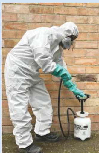
Pulverizador Manual de gotas gruesas marca Hudson para aspersiones residuales y de choque.
